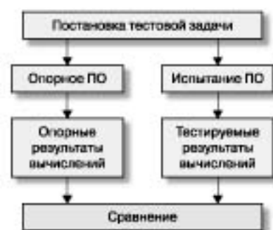
Схема тестирования ПО Сургутского ЗСК (опорный программный продукт разработан на основе вычислительных алгоритмов, используемых в тестируемом ПО)
